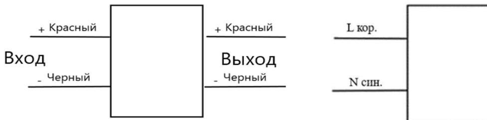
Схема подключения к сети постоянного тока ( 24 В.)
