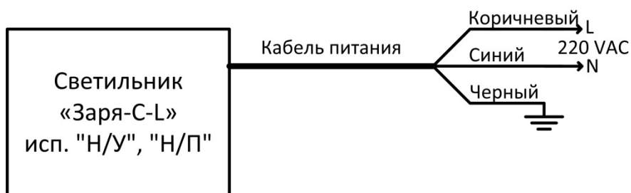
Рисунок 1.11. Схема подключения светильника «Заря-С-L» исп. «Н/У», «Н/П».
